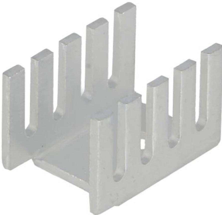
Dissipatore di calore in alluminio per componenti con package TO220 con resistenza termica: 27°C/W. Dimensioni (mm): 19,05x13,21x12,7, peso: 1,566 grammi.
