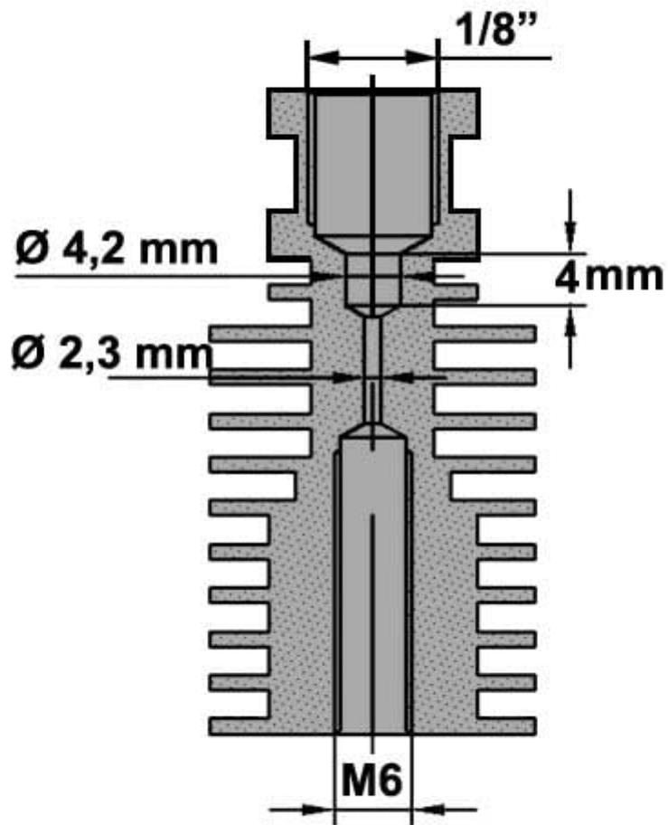
Dissipatore in alluminio per testina di stampa della stampante DMAKE (E3DV5). Utilizzabile solo con filamenti da 1,75 mm. Corpo esterno: lunghezza 50 mm, diametro maggiore 24,9 mm, diametro minore 16 mm. Filetto nozzle M6, filetto guida 1/8".
