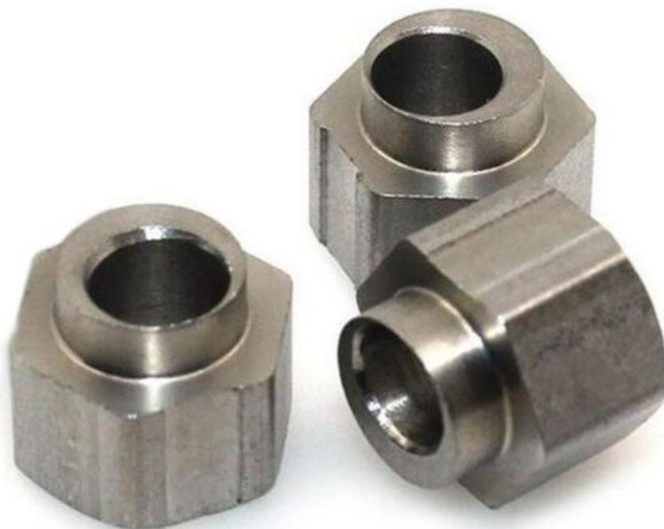
Distanziale eccentrico da 6 mm in acciaio INOX per sistemi OpenBuilds con foro Ø 5 mm. Montato sul perno delle pulegge, di un carrello per movimentazione lineare, permette di regolare a proprio piacimento il precarico delle stesse mediante chiave fissa da 10 mm. Confezione da 1 pz.
