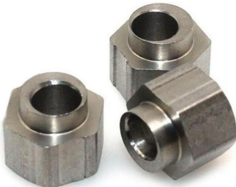
Distanziale eccentrico da 6,35 mm in acciaio INOX per sistemi OpenBuilds con foro Ø 5 mm. Montato sul perno delle pulegge, di un carrello per movimentazione lineare, permette di regolare a proprio piacimento il precarico delle stesse mediante chiave fissa da 10 mm. Confezione da 1 pz.
