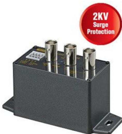
Dispone di un ingresso e di due uscite video con attacco BNC. Permette di trasmettere il segnale fino ad una distanza massima di 1000 metri utilizzando cavi coassiali RG59. LED rosso di indicazione on/off e regolazione separata su ciascuna uscita della luminosità e del contrasto dell'immagine. Viene fornito completo di adattatore di rete.
