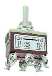
Doppio deviatore di potenza a levetta (a ritenuta) in grado di attivare carichi con assorbimento massimo di 10 A a 250 V. Tipo: DPDT (Doppio polo doppio contatto). La levetta può essere spostata verso un contatto laterale o l'altro. Dimensioni 33x20x57,7 mm. Diametro foro di fissaggio: 12,2 mm. Terminali con morsetto a vite.
