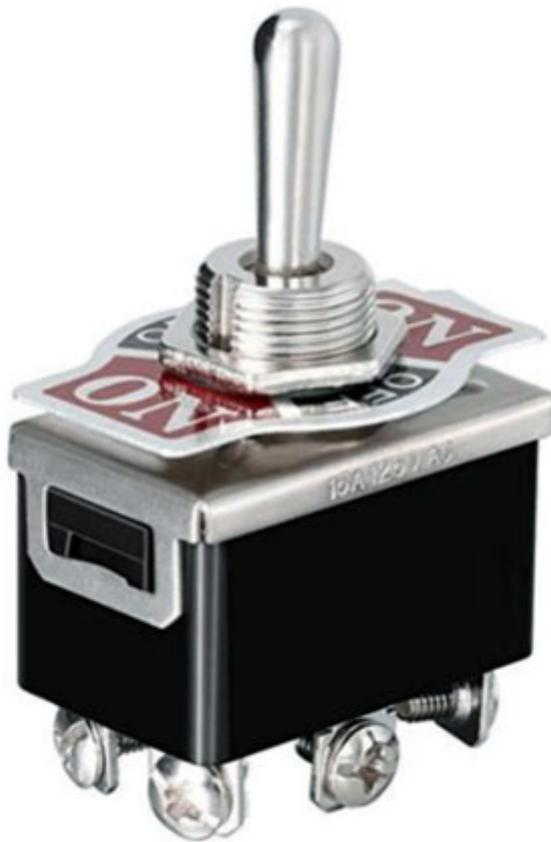
Doppio deviatore di potenza a levetta 3 posizioni (a ritenuta) in grado di attivare carichi con assorbimento massimo di 10 A a 250 V. Tipo: DPDT (Doppio polo doppio contatto). È un doppio deviatore con posizione centrale stabile **ON-OFF-ON**. La levetta può essere spostata in posizione centrale o laterale (su un contatto o sull'altro). Dimensioni 33x20x57,7 mm. Diametro foro di fissaggio: 12,2 mm. Terminali con morsetto a vite.
