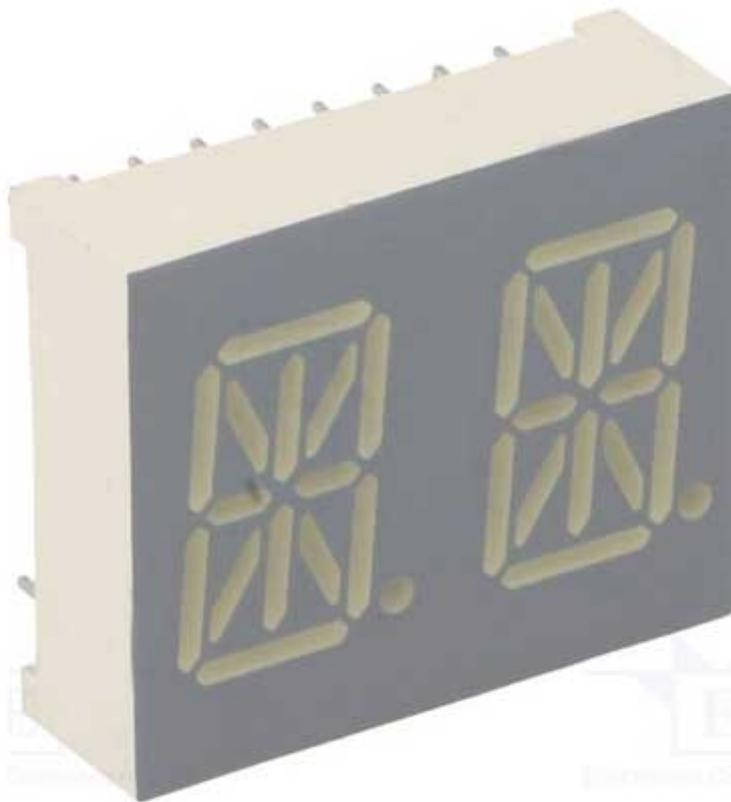
Doppio display alfanumerico (14 segmenti) a LED rosso con anodo comune. Alimentazione da 1,85 a 2,5 Vdc, altezza digit (mm): 13,8, dimensioni esterne display (mm): 25,2x21,2x7,8. Utilizzato nel progetto della "SLOT MACHINE" versione portatile pubblicato sulla rivista [Elettronica In n. 216 - Giugno 2017](#).
