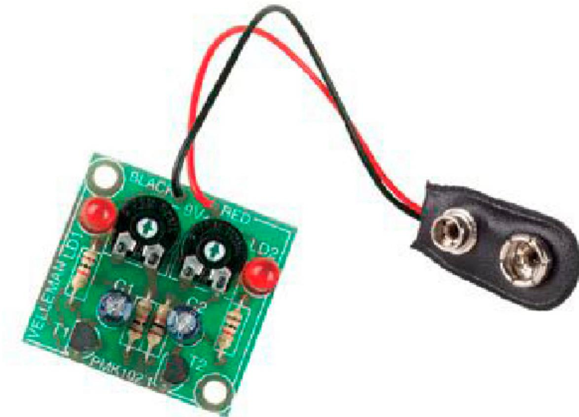
Idoneo per impieghi diversi come modellismo e ricreazione. Velocità di lampeggio regolabile per mezzo di due potenziometri.
