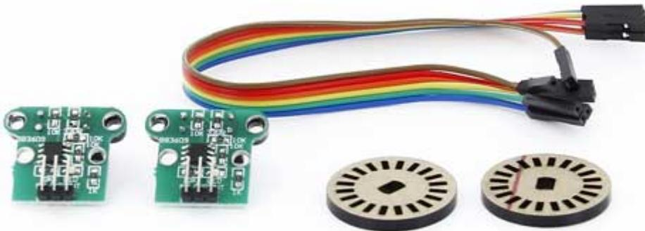
Composto da due encoder ottici e due dischi da inserire sull'albero motore, questo set permette di misurare la velocità fornendo 20 conteggi per ogni giro completo. Alimentazione: da 4,5 a 5,5 Vdc, frequenza di misurazione: 100 kHz, diametro disco: 26 mm, risoluzione encoder: 20 linee. N.B. la confezione non comprende i motori.
