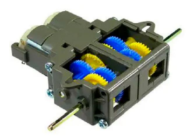
Doppio motoriduttore composto da due motori indipendenti e una serie di ingranaggi.Le configurazioni possibili dei rapporti sono 12,7:1 - 38,2:1 - 114,7:1 e 344,2:1.E' possibile montare rapporti differenti per ciascun lato.Dal DGEARBOX escono due assi esagonali della lunghezza di 50 mm e del diametro di 3 millimetri sui quali vengono inserite le ruote del robot. I motori funzionano con una tensione da 3 a 6 Vdc.
