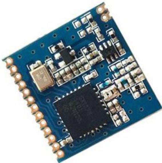
Compatto modulo ricetrasmittitore RF a 433 MHz basato sul chip SX1278 della Semtech Corporation. È dotato di 6 I/O digitali, una elevata sensibilità (-136dBm) in modulazione LoRa™ e una elevata potenza d'uscita (20dBm). È particolarmente indicato per essere utilizzato in telecomandi, contatori intelligenti, Home Automation, logger personali, rete di sensori wireless, periferiche wireless per PC, ecc.
