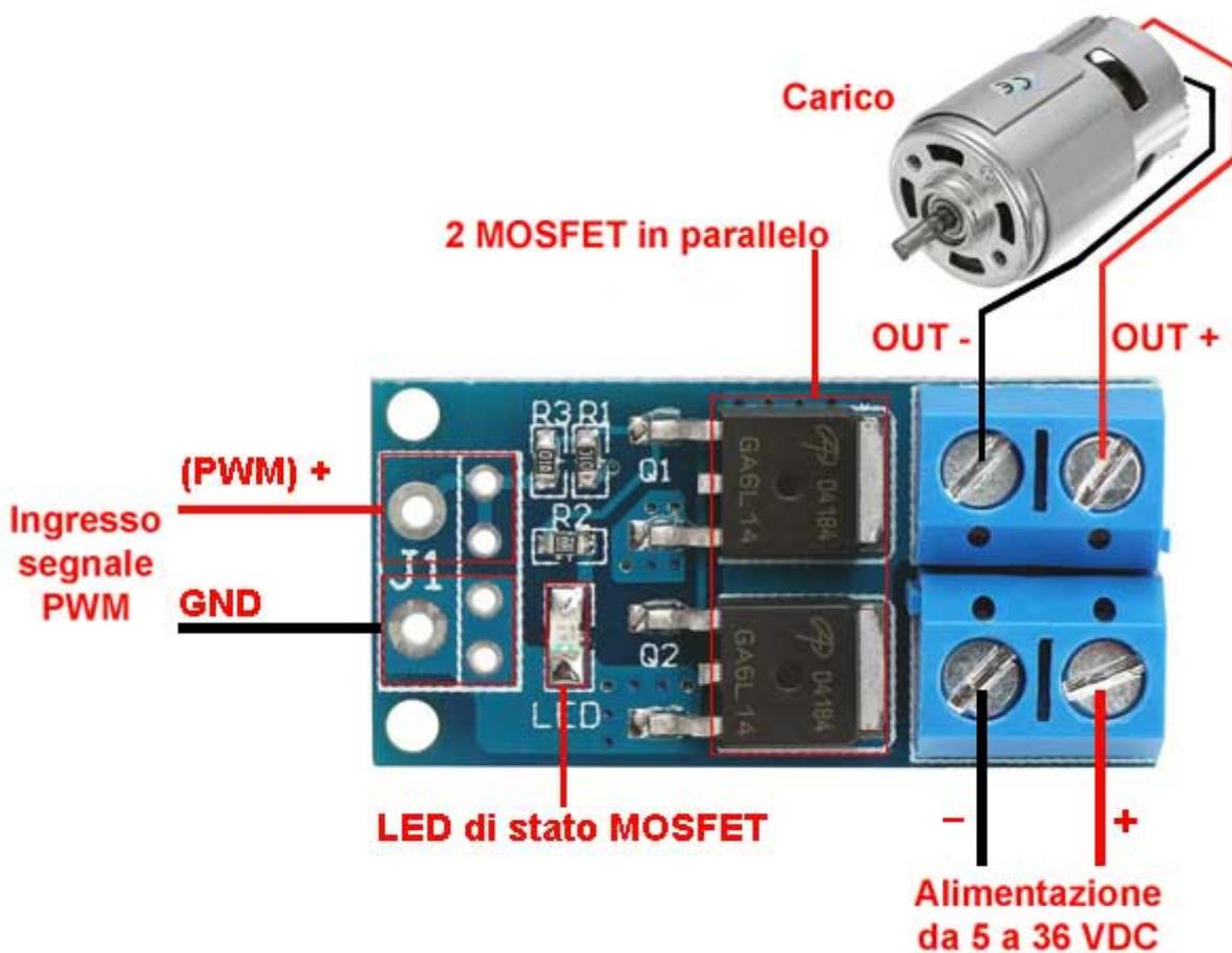
Piccolo modulo basato su due MOSFET collegati in parallelo che permette, inviando un segnale PWM in ingresso con frequenza max di 20 kHz (trigger: 0V uscita disabilitata - 3,3V÷20V uscita attiva), di controllare motori DC, mini pompe DC e altri carichi con alimentazione compresa tra 5 e 36 Vdc e 15 A (max 400 watt). Può essere interfacciato ad Arduino, Fishino, PLC o altro. Dimensioni (mm): 34x17x12, temperatura di funzionamento: da -40°C a +85°C.
