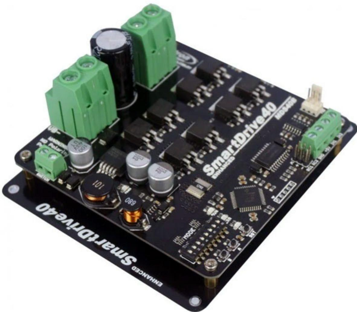
Compatto driver di potenza in grado di gestire 1 motore DC con una tensione di alimentazione compresa tra 10 VDC e 45 VDC e una corrente max. di 40 A (80 A di picco).
