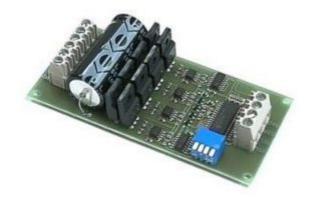
Il modulo MD22 è un potente driver per pilotare due motori DC, necessita di una tensione di 5 Vdc per la logica di controllo e fino a 24 Vdc per i motori. Può essere controllato tramite I2C bus, in modo analogico ( 0 V indietro, 2,5 V stop, 5 V avanti) o RC mode (collegato al ricevitore di un radiocomando tipo modellismo).
