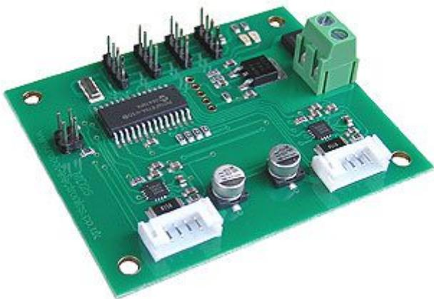
Il modulo MD25 è un robusto driver con controllo I2C o seriale per due motori, può essere interfacciato ad una vasta gamma di microcontrollori come: PICAXE, OOPic, BS2p, PIC, AVR, 8051's ecc. È in grado di controllare la velocità e la direzione dei motori. Particolarmente indicato per essere utilizzato con i motoriduttori EMG30. Dimensioni: 110 mm x 52 mm x 25 mm.
