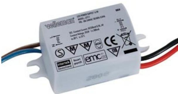
Progettato specificatamente per pilotare in corrente fino a 3 LED con potenza massima di 1 watt. Può essere impiegato sia in ambienti interni che all'esterno (grado di protezione IP65). Integra funzioni di protezione da sovracorrente e cortocircuito. Alimentazione con tensione alternata (100 - 240 Vac), elevata stabilità della corrente in uscita (350 mA).
