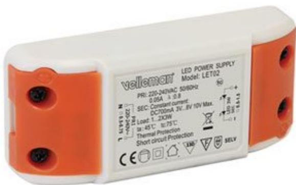
Modulo a corrente costante in grado di alimentare fino a 2 LED con potenza massima di 3 Watt ciascuno. Dispone di protezione contro cortocircuiti e sovracorrente. Alimentazione: 220-240 VAC 50/60 Hz, equivalente [SELV](#). Non richiede alcun dissipatore di calore. **N.B.** solo per utilizzo all'interno.
