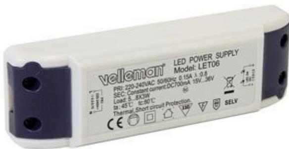
Modulo a corrente costante in grado di alimentare fino a 8 LED con potenza massima di 3 Watt ciascuno. Dispone di protezione contro cortocircuiti e sovracorrente. Alimentazione: 220-240 VAC 50/60 Hz, equivalente [SELV](#). Non richiede alcun dissipatore di calore. **N.B.** solo per utilizzo all'interno.
