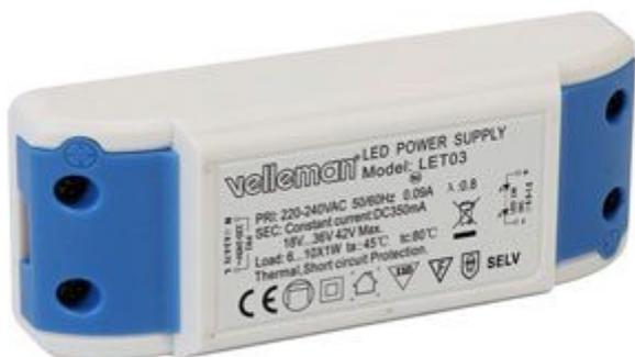
Modulo a corrente costante in grado di alimentare fino a 10 LED con potenza massima di 1 Watt ciascuno. Dispone di protezione contro cortocircuiti e sovracorrente. Alimentazione: 220-240 VAC 50/60 Hz, equivalente [SELV](#). Non richiede alcun dissipatore di calore. **N.B.** solo per utilizzo all'interno.
