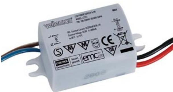
Progettato specificatamente per pilotare in corrente un LED con potenza massima di 1 watt. Può essere impiegato sia in ambienti interni che all'esterno (grado di protezione IP65). Integra funzioni di protezione da sovracorrente e cortocircuito. Alimentazione con tensione alternata (100 - 240 Vac), elevata stabilità della corrente in uscita (350 mA ).
