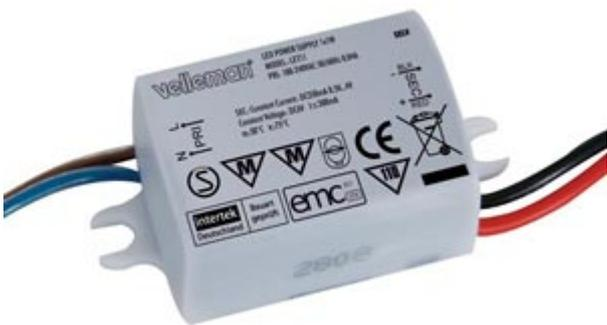
Progettato specificatamente per pilotare in corrente un LED con potenza massima di 3 watt. Può essere impiegato sia in ambienti interni che all'esterno (grado di protezione IP65). Integra funzioni di protezione da sovracorrente e cortocircuito. Alimentazione con tensione alternata (100 - 240 Vac), elevata stabilità della corrente in uscita (700 mA ).
