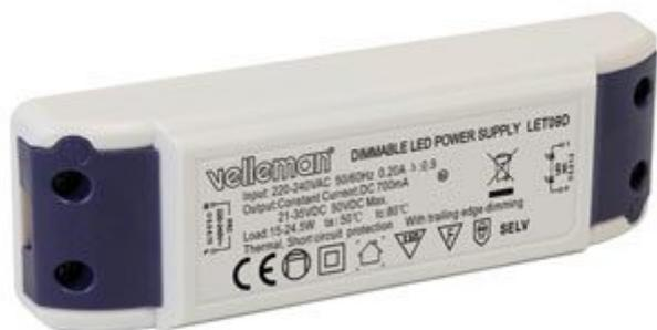
Modulo a corrente costante in grado di alimentare fino a 10 LED con potenza massima di 3 Watt ciascuno. Dimmerabile, dispone di protezione contro cortocircuiti e sovracorrente. Alimentazione: 220-240 VAC 50/60 Hz, equivalente [SELV](#). Non richiede alcun dissipatore di calore. **N.B.** solo per utilizzo all'interno.
