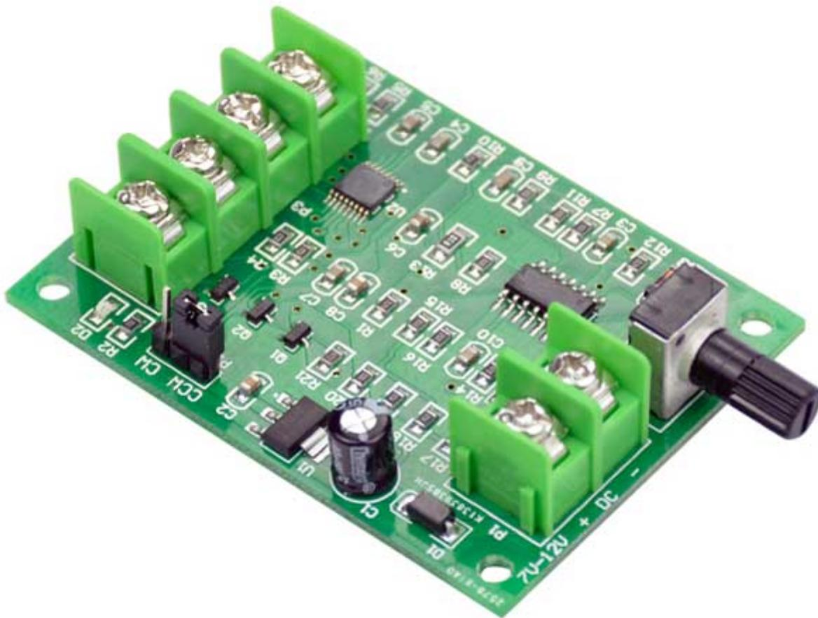
Driver per piccoli motori brushless (senza sensore di Hall) a 3 e 4 fili con alimentazione compresa tra 7 e quelli presenti negli hard disk, lettori CD, ecc. Dispone di potenziometro per la regolazione della velocità, impostare il senso di rotazione, LED di stato per alimentazione. Inoltre è dotato di protezione da inversioni sovracorrente. Velocità massima è 10.000 rpm.
