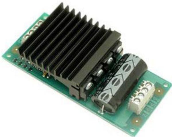
Il modulo MD03 è un potente driver per pilotare motori DC, necessita di una tensione di 5 Vdc per la logica di controllo e può gestire un motore con tensione da 5 a 24 Vdc e una corrente massima di 20 A. Può essere controllato tramite I2C bus (possono essere pilotati fino ad 8 moduli), in modo analogico ( 0 V indietro, 2,5 V stop, 5 V avanti), in modo analogico 0V-5V (con controllo direzione separato), RC mode (collegato al ricevitore di un radiocomando tipo modellismo) o PWM.
