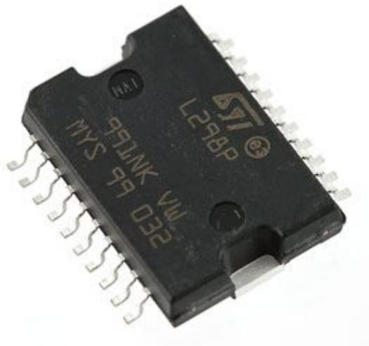
Versione SMD dell'integrato L298N (driver doppio full bridge per motori DC e passo passo). Tensione di alimentazione da 4,5 a 7 V, tensione di alimentazione motore da 7 a 46 Vdc, corrente di picco in uscita per canale: 2 A, contenitore PowerSO20.
