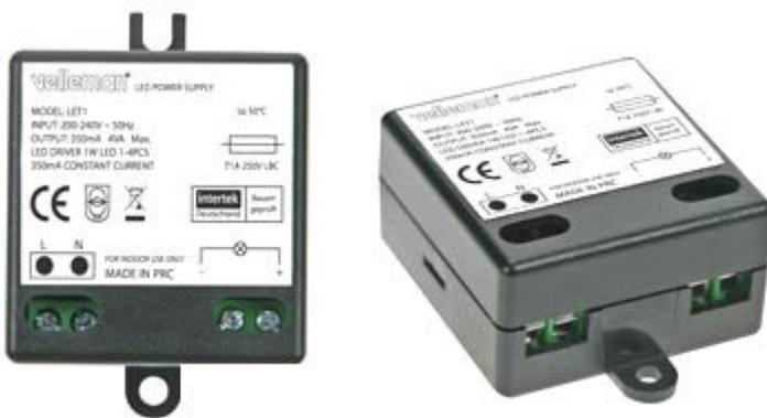
Modulo in grado di alimentare fino a quattro LED di potenza da 1 Watt cadauno. Protezione contro cortocircuiti e sovracorrente, alimentazione con tensione alternata (220 Vac), dimensioni 40,2 x 42,2 x 22 mm. Non richiede alcun dissipatore di calore.
