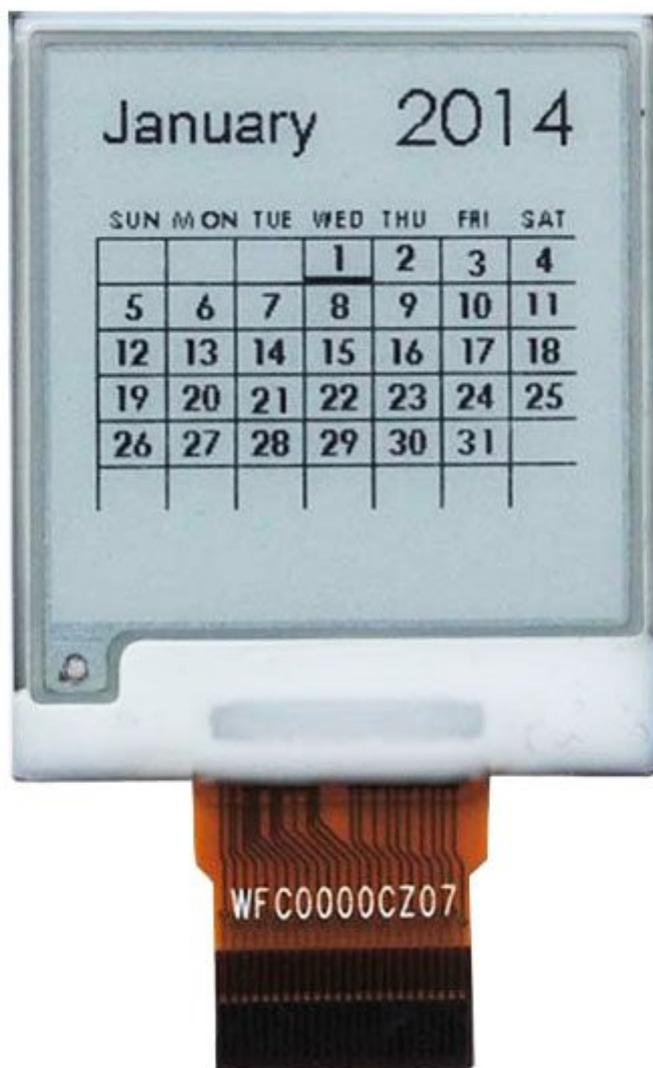
Display e-Paper o Paper Ink ([elettroforetico](#)) a matrice attiva TFT. Dispone di area attiva da 1,54 pollici, una risoluzione di 200 (H) x 200 (V) pixel, elevato contrasto, ampio angolo di visione, consumo ultra ridotto, modalità di visualizzazione verticale o panoramica (orizzontale), superficie antiriflesso e modalità sleep per un basso consumo di corrente.
