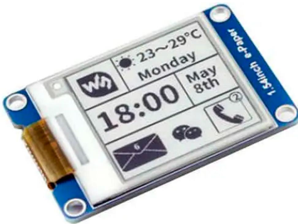
Display e-Paper o Paper Ink ([elettroforetico](#)) a matrice attiva TFT. Dispone di area attiva da 1,54 pollici, una risoluzione di 200 (H) x 200 (V) pixel, elevato contrasto, ampio angolo di visione (>170°), interfaccia SPI per l'utilizzo con controller come Raspberry Pi / Arduino / Nucleo, ecc, consumo ultra ridotto, modalità di visualizzazione verticale o panoramica (orizzontale), superficie antiriflesso e modalità sleep per un basso consumo di corrente.
