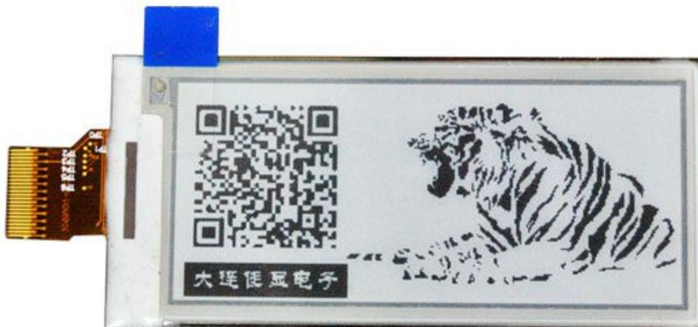
Display e-Paper o Paper Ink ([elettroforetico](#)) a matrice attiva TFT. Dispone di area attiva da 2,13 pollici, una risoluzione di 122 (H) x 250 (V) pixel, elevato contrasto, ampio angolo di visione, consumo ultra ridotto, modalità di visualizzazione verticale o panoramica (orizzontale), superficie antiriflesso e modalità sleep per un basso consumo di corrente.
