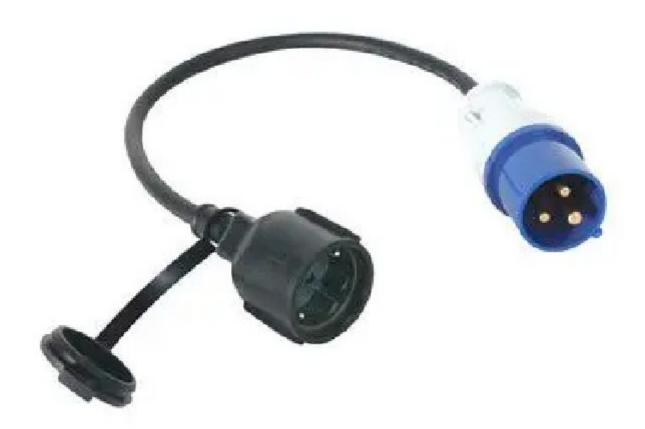
Cavo adattatore da presa Schuko a spina volante CEE 3 poli per connettere dispositivi elettrici in modo efficiente e sicuro. Con una lunghezza di 40 cm e un robusto cavo di tipo H07RN-F 3G2.5, questo adattatore è progettato per offrire prestazioni affidabili e durature. Che tu debba collegare
