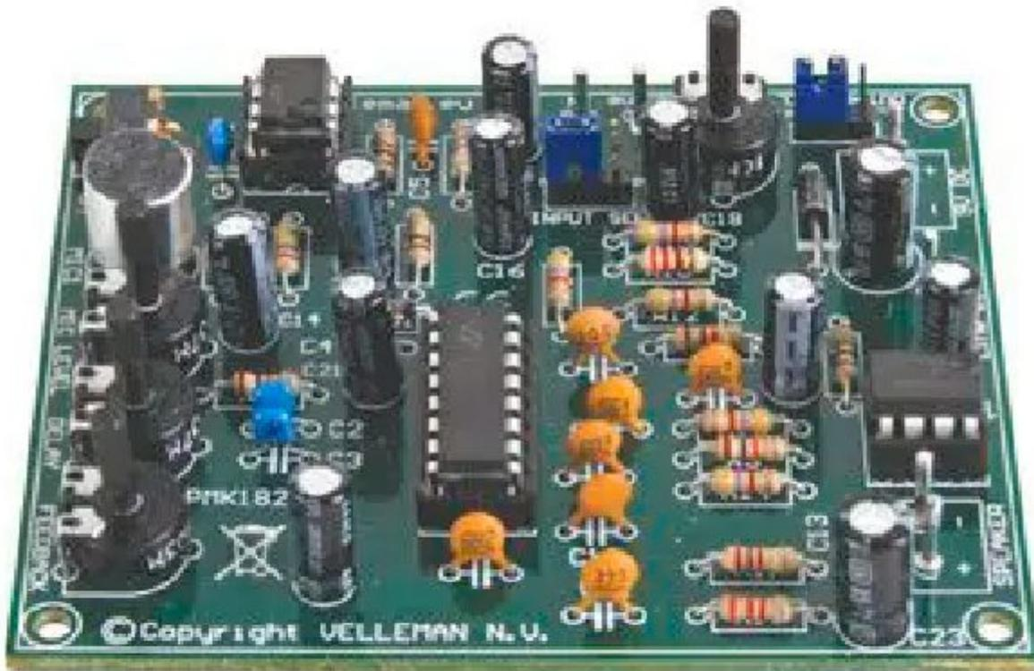
Può essere utilizzato con diversi sistemi audio come karaoke, megafoni, public address, giocattoli o solo per divertimento. Dispone di 40 Kb di SRAM che permette di avere una bassa distorsione e un'ottima qualità del suono, microfono onboard, uscita amplificata per altoparlante, Line-In e Line-out. Regolazione volume, tempo di ritardo eco e feedback.
