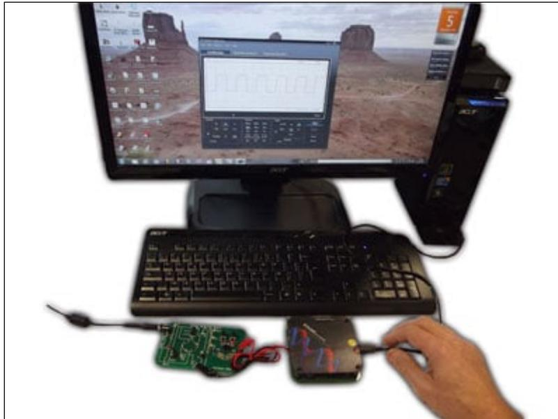
Finalmente uno strumento economico e semplice da realizzare pensato per chi si avvicina al mondo dell'elettronica! Costruisci con le tue stesse mani questo mini oscilloscopio che, abbinato al PC, ti permetterà di effettuare qualsiasi misurazione e di visualizzare i segnali proprio come uno strumento convenzionale. Funziona come oscilloscopio, analizzatore di spettro e registratore di transienti. Puntali inclusi.
