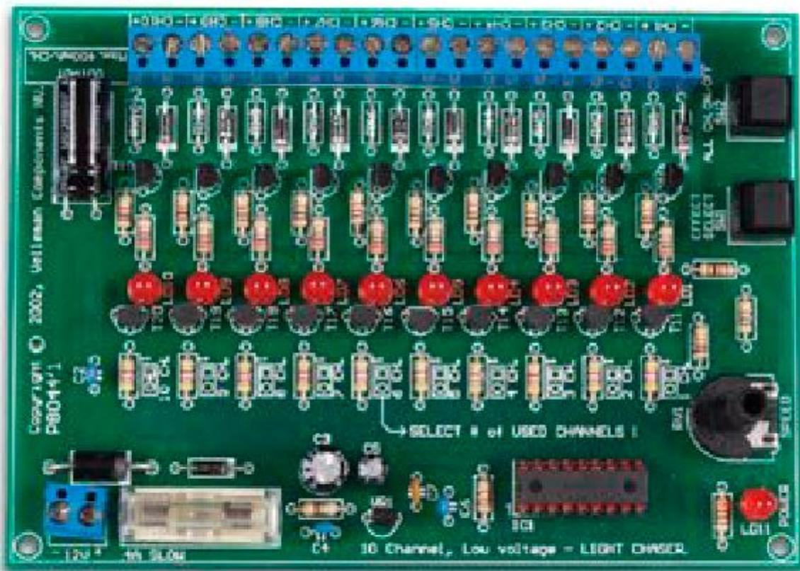
Dispone di 10 uscite (12V/400mA) per controllare altrettante lampade, relè "solid state", ecc. Utilizzabile per realizzare luci di avvertimento, luci da party, luci per discoteche, ecc.
