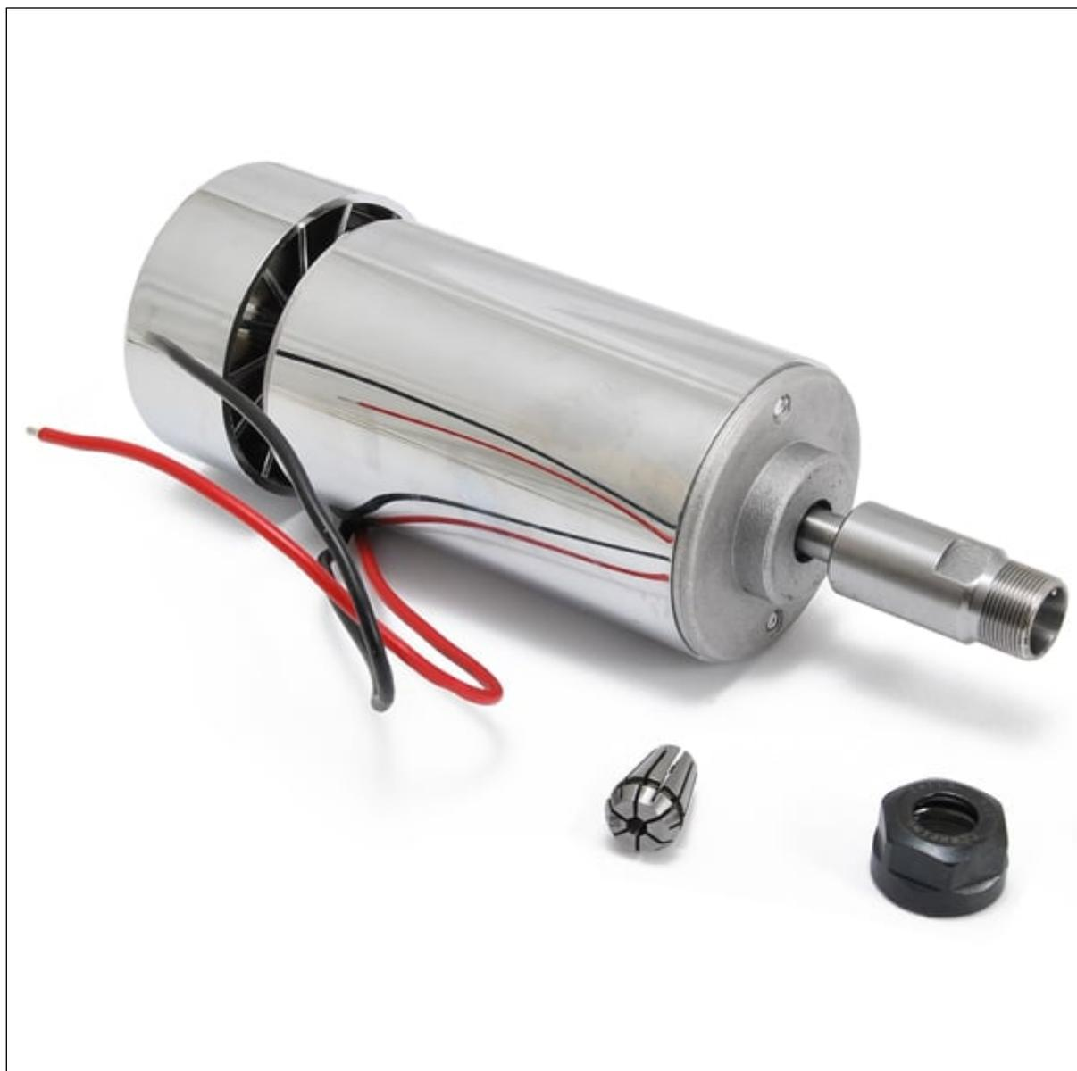
Elettromandrino autoventilato dotato di albero di precisione in acciaio rettificato, velocità: da 3.000-12.000 giri / minuto, alimentazione: da 12 Vdc a 48 Vdc, potenza: 300 watt, attacco per pinze ER11. Ideale per incidere, forare, fresare, smerigliare, lucidare.
