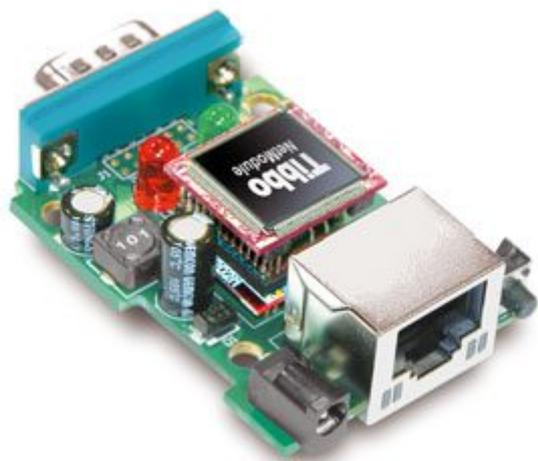
Scheda di valutazione per i moduli EM1202 Tibbo. La confezione comprende la demoboard (EM1202-EV) completa di 1 modulo EM1202, 1 cavo con connettore seriale DB9 M/F, 1 cavo con connettore seriale DB9 F/F, 1 cavo UTP schermato con connettori RJ45 e un adattatore di rete da 12 Vdc / 0,5 A.
