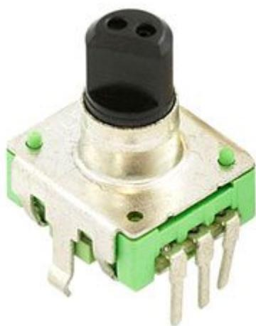
[Encoder](#) rotativo a 12 passi/360° (30° a passo). Il segnale di uscita è basato sul codice [gray](#) che permette di conoscere in quale direzione l'encoder è stato ruotato. Dispone inoltre di un pulsante n.a. che si attiva quando l'alberino dell'encoder viene premuto verso il basso. Manopola non compresa.
