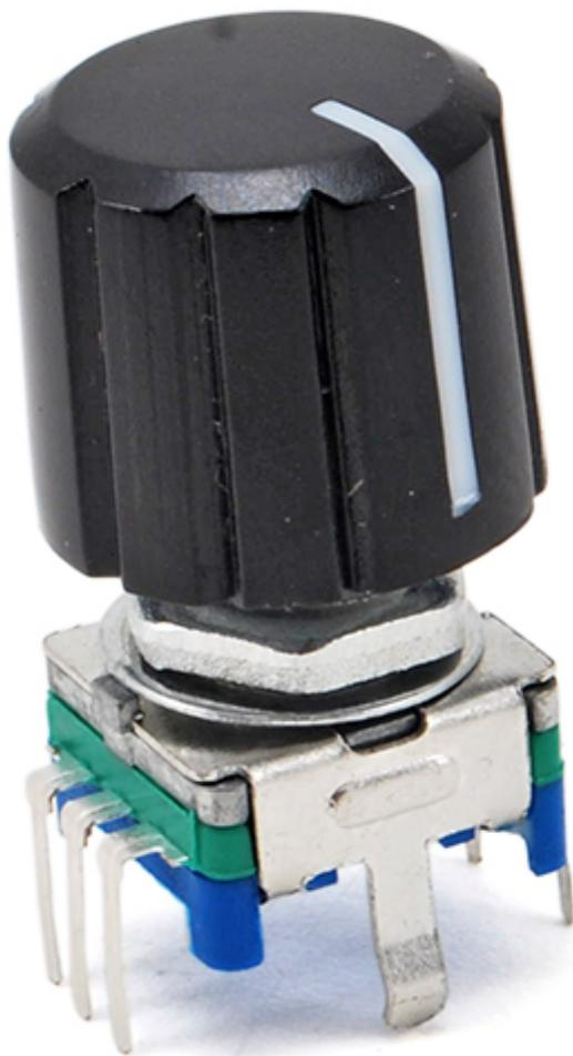
[Encoder](#) rotativo Encoder rotativo 12 mm con manopola a 20 passi/360° (18° a passo). Il segnale di uscita è basato sul codice [gray](#) che permette di conoscere in quale direzione l'encoder è stato ruotato. Dispone inoltre di un pulsante n.a. che si attiva quando l'alberino dell'encoder viene premuto verso il basso. Manopola compresa.
