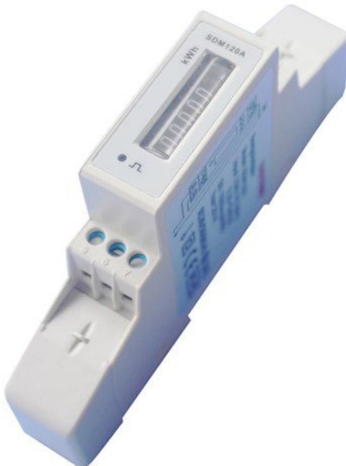
Compatto e preciso modulo conta energia per sistema monofase. Dispone di display analogico in grado di visualizzare fino a 99999,9 kWh, dispone di LED indicatore che lampeggia ad ogni impulso e uscita impulsiva 1000 imp/kWh. Contenitore per montaggio su guide DIN standard (1 modulo). Il modulo qui proposto è un contatore della potenza consumata pertanto non fornisce indicazioni sul consumo istantaneo. Il valore mostrato non è resettabile.
