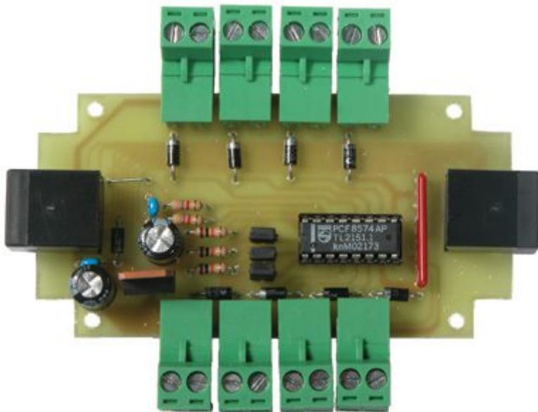
Espansione 8 ingressi digitali basata sull'integrato I2C-Bus PCF8574A. La scheda è dotata di due connettori tipo RJ45 collegati tra loro in parallelo. Il kit comprende tutti i componenti, la basetta forata e serigrafata, i morsetti a vite ad innesto; non è compreso il contenitore plastico.
