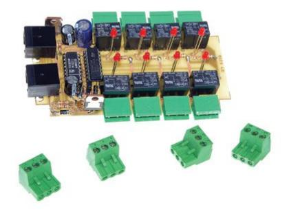
Permette di espandere (con otto uscite a relè) qualsiasi dispositivo in grado di sfruttare una linea I2C-BUS per comandare un I/O expander PCF8574. Il kit comprende tutti i componenti, compresi gli 8 morsetti ad innesto e i due connettori RJ45, la basetta forata e serigrafata, e un cavo RJ45 della lunghezza di circa 10 cm. Il contenitore non è incluso.
