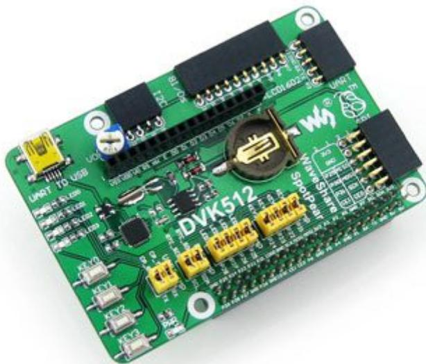
Ideale per essere utilizzata in abbinamento a Raspberry Pi (Raspberry Pi 3 B+, Raspberry Pi 3 B, Raspbe LCD16x2, connettore GPIO Raspberry Pi, 4 pulsanti e 4 LED configurabili dall'utente, buzzer, trimmer, RT colorati) e CD rom contenente: manuale utente (in Inglese), documentazioni di sviluppo (configurazione R source code).
