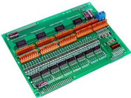
Scheda di interfacciamento opto-isolata per modulo CT1720 che rende disponibili le risorse del modulo all'esterno. Sui vari connettori sono così disponibili 32 ingressi, 32 uscite open-collector e 8 ingressi A/D. Dimensioni 130 x 95 x 14 mm. Alimentazione 24 Vdc.
