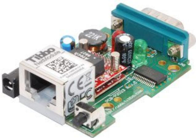
Scheda di valutazione per i moduli EM203 Tibbo. Questo circuito consente un rapido apprendimento delle funzionalità del modulo di conversione Ethernet/seriale EM203 (la scheda viene fornita con un modulo). Il dispositivo può essere utilizzato come un Server Device stand-alone. L'Evaluation board implementa un pulsante di setup, una seriale RS232 con connettore DB9M, i led di stato e uno stadio switching al quale può essere applicata la tensione di alimentazione (9-24 Vdc).
