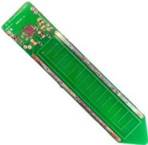
**SMS** Il sensore Blebrick SMS viene utilizzato per misurare l'umidità del terreno e può essere configurato per misurare la resistenza del terreno, la mutua capacità tra gli elettrodi e la capacità assoluta rispetto a GND.
