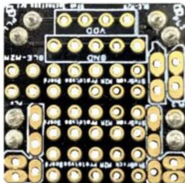
**PCB** Il Blebrick PCB è una base singola che include delle piazzole forate per fornire all'utente una basetta millefori compatibile con i Blebricks. Questo Blebrick è pensato appositamente per l'utente avanzato che può sperimentare l'assemblaggio di componenti integrati come pulsanti, interruttori, LED, sensori analogici ecc.
