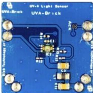
**UVA** Il Blebrick UVA è un sensore di luce ultravioletta (UV-A).
