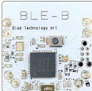
**BLE-B:** Il BLE-B è il mattoncino di base delegato alla gestione operativa del sistema e delle comunicazioni tramite Bluetooth Low Energy BLE 4.2 (distanza di comunicazione in aria ca 20 mt).
