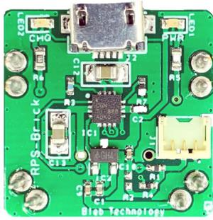
**RPS:** Il Blebrick RPS è un modulo di alimentazione che include un caricatore per batterie Li-Po / Li-Ion micro-USB (Type B).
