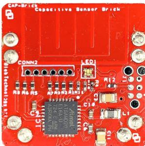
**CAP:** Il Blebrick CAP è un sensore touch capacitivo.
