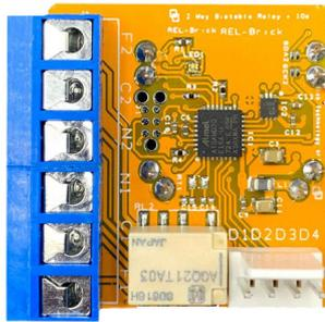
**REL:** Il Blebrick REL è un attuatore che include un relè bistabile (che gestisce contemporaneamente due canali), 2 ingressi digitali e 2 uscite digitali.
