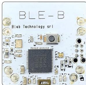
**BLE-B:** Il BLE-B è il mattoncino di base delegato alla gestione operativa del sistema e delle comunicazioni tramite Bluetooth Low Energy BLE 4.2 (distanza di comunicazione in aria ca 20 metri).
