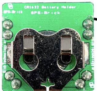
**SPS** Il Blebrick SPS è un modulo di alimentazione che include un supporto per una batteria a bottone (CR1632).
