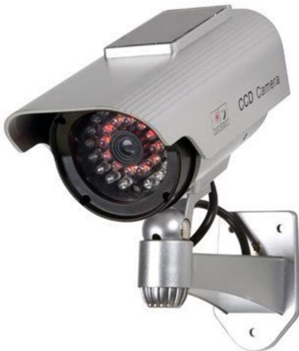
Falsa telecamera con staffa, 12 LED che simulano i LED IR, pannello solare per la ricarica delle batterie, corpo in materiale ABS e resistente alle intemperie. Dimensioni (mm): 200x170x80, peso: 285 grammi. Alimentazione: 2 batterie ricaricabili da 1,2V AAA (non comprese). **Attenzione:** utilizzare solo batterie ricaricabili !
