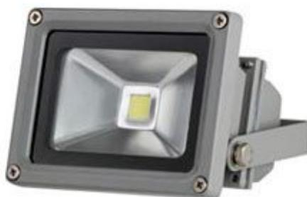
Faretto da esterno con lampada costituita da 1 LED bianco Epistar da 10 watt. Flusso luminoso: 600 lumen, temperatura colore: 3000 K, angolo di emissione: 120°, grado di protezione IP65, alimentazione: 230 Vac. Completo di staffa di montaggio.
